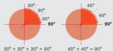
**CONSEJO:** En el método angular, los ajustes deben ser aplicados de una vez, en forma pareja y firme. Si detiene el ajuste a medio camino o afloja la tensión que le esta aplicando antes de llegar a la posición final, es muy probable que el torque aplicado no sea el valor que especificó el fabricante.
