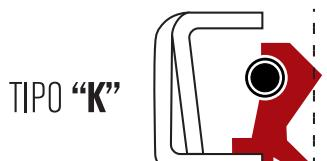
Diseños de estructura reforzada, que ofrecen mayor protección para la zona del labio de retención.
