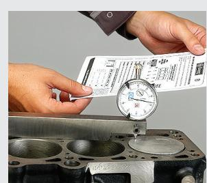
Recuerde que la disminución en la cámara de combustión provocará aumentos de temperatura y presión, sometiendo a esfuerzos a los componentes del motor, para los que no han sido diseñados.
