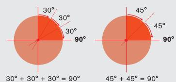
**CONSELHO:** No método angular os ajustes devem ser aplicados de uma vez de forma igual e firme. Caso se interrompa o ajuste na metade do caminho ou se afrouxe a tensão que se está aplicando antes de chegar à posição final é muito provável que o torque aplicado não seja o valor especificado pelo fabricante.
