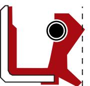
A construção em borracha permite a montagem do Retentor em alojamentos danificados, ou seja, que apresentem apenas riscos ou pequenas corrosões. Já a construção metálica, oferece uma ancoragem mais firme, porém não é indicado para alojamentos que apresentem as mesmas condições de danos.
