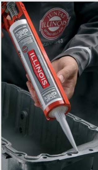
Sellador Alto Módulo Neutro - Formajunta RTV Alta Temperatura
