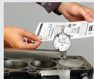
No caso de motores a diesel, medir com um comparador a altura máxima dos pistões com relação ao bloco; a medida mais alta será tomada como referência. Com base nessa medida, selecione a espessura da junta (travamento).
