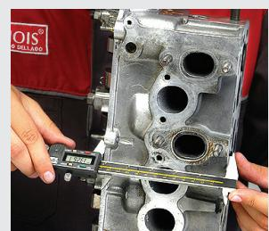
Compruebe que la tapa de cilindros no este excesivamente rectificada, una junta por si misma no puede compensar esta diferencia de altura (en ciertos casos pueden tocar las válvulas contra el pistón o incrementarse en exceso la relación de compresión); si esto ocurriese consulte por juntas especiales en sobremedida o reforzadas.
