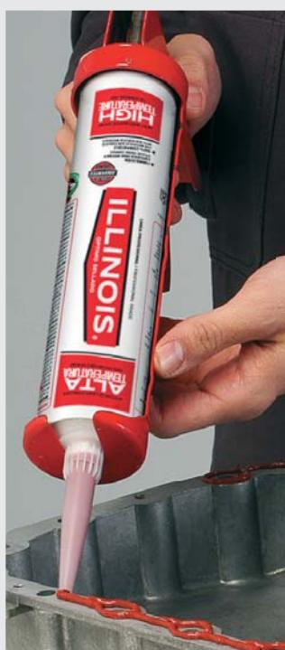
**Selador - Forma junta RTV Alta Temperatura**
