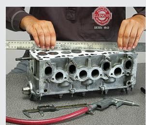
**CONSEJO:** Como regla general, si se desmonta la tapa de cilindros de un motor equipado con una junta de lámina y la reparación es sólo de la parte superior (es decir, el block no es desmontado), al momento de realizar el armado utilice una junta tipo "METALGRAF®", ya que ésta absorberá mejor las diferencias que pueda tener el plano del block. En la elección de la junta considere la variación de la relación de compresión.
